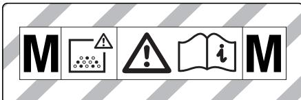
**ПРЕДОСТЕРЕЖЕНИЕ!** Этот прибор содержит опасную для здоровья пыль. Опорожнение и обслуживание, включая удаление мешка с пылью, должны проводиться только специалистами, которые имеют специальную индивидуальную защитную экипировку. Не следует включать прибор, прежде чем не установлен полный комплект системы фильтров и не проведена проверка функционирования контроля над объемом потока.
